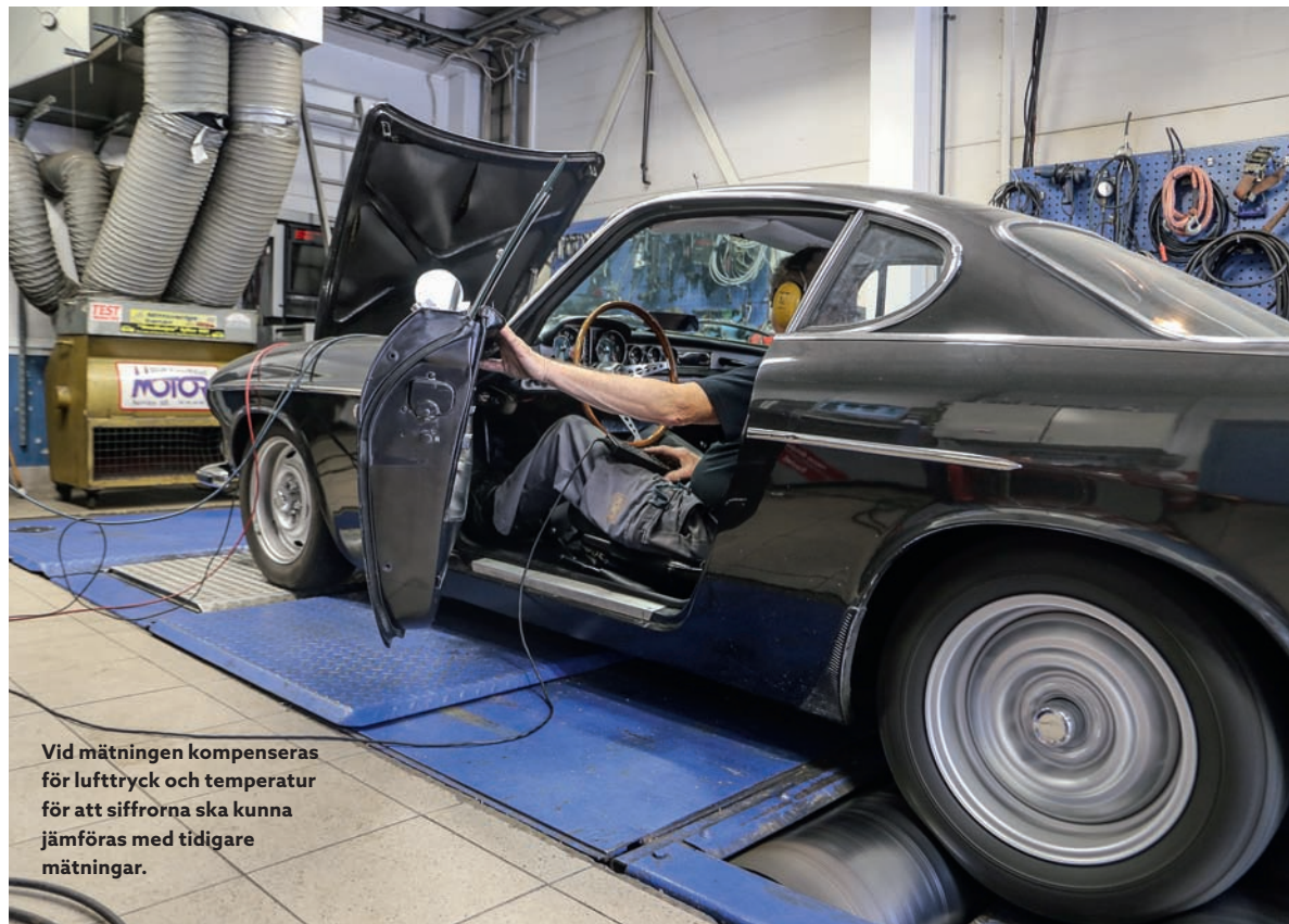
Effekten mäts på drivhjulmen räknas om till motoreffekt.
